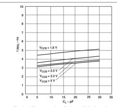
Load Capacitance T<sub>A</sub> = 25°C, V<sub>CCA</sub> = 2.5V
